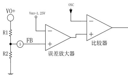
图 8.5 EG1192H 输出电压调整电路
